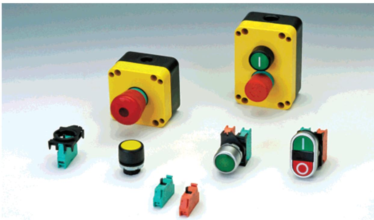
Montage en façade dans Ø de perçage 22.5 mm, degré de protection IP65, disponibles en versions collerettes noires ou chromées, arrêts d'urgence EN418, bornes à vis, à ressorts ou à souder sur circuits imprimés. Boîtes à boutons jusqu'à 3 fonctions, ou boîtes vides jusqu'à 6 orifices. Versions pour systèmes pneumatiques.
